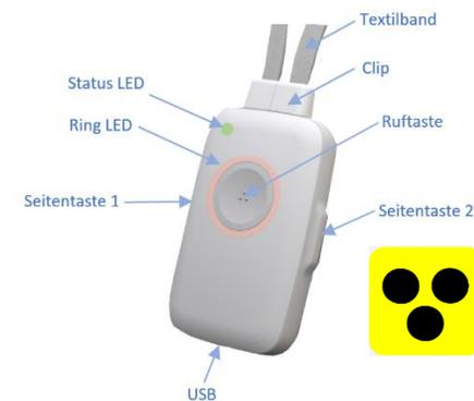
**DECT Telecare** (dispositivo) è un telefono cordless DECT con funzioni di sicurezza per il tuo sistema telefonico. Il dispositivo è adatto per i non vedenti.
