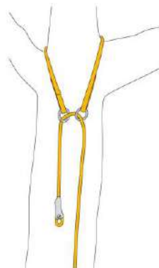
Fig. 8 - Ancoraggio passante per corda raddoppiata
