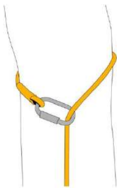
Fig. 2 - Strozzo diretto della fune
